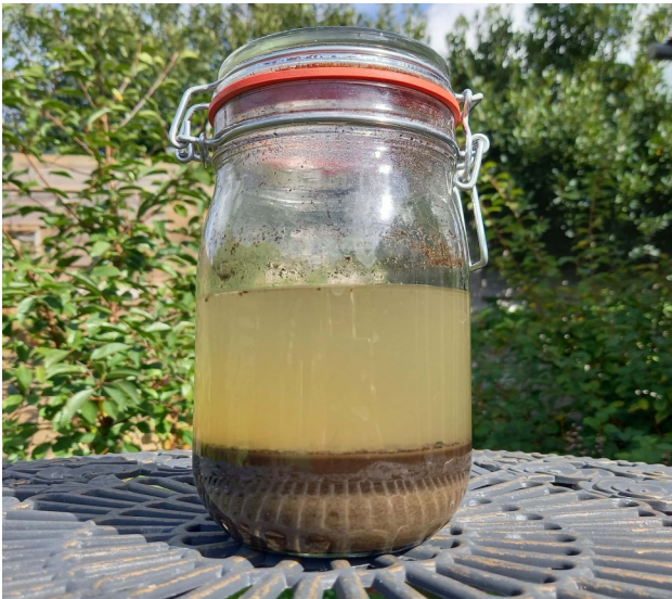
Glazen pot met schuttetestresultaat. Door de laagjes te meten kunnen de percentages per laag worden bepaald.
