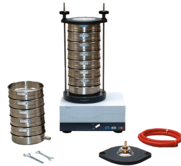
Korrelgrootte analyseset met elektromagnetische zeefschutmachine
